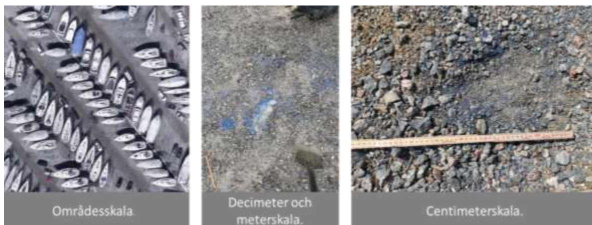
Figur 16. Halter och ämnestyper kan variera beroende på typ av båtbottnfärg och hur ofta en båt med en viss typ av färg stått på samma plats inom ett område. Halterna varierar även då det ofta förekommer spill eller ackumulering av färgflagor lokalt över mindre yta. Även i en provtagningspunkt kan halterna variera beroende på ackumulering av färgflagor, se de blå prickarna i fotot till höger.
