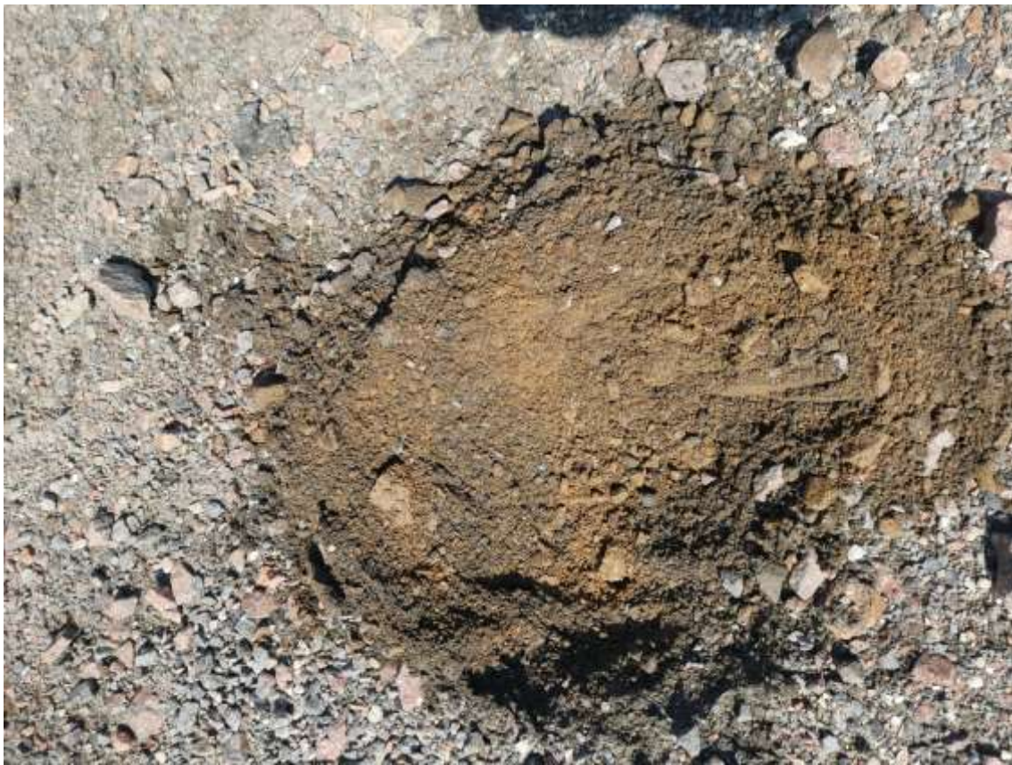
Figur 2. Exempel på provgrop vid uttag av inkrement.
