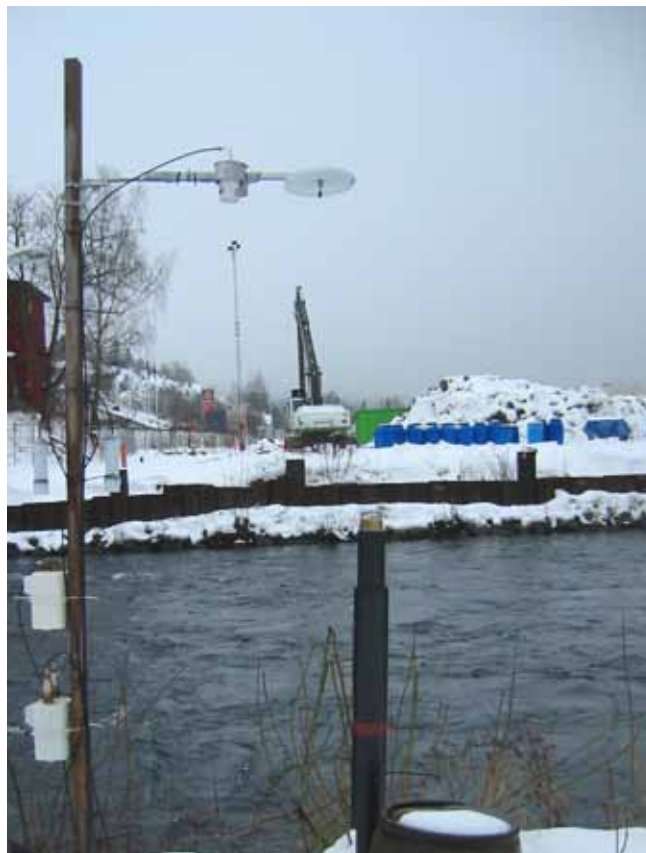
Figur 8.3: Station för mätning av atmosfärisk deposition av kvicksilver
