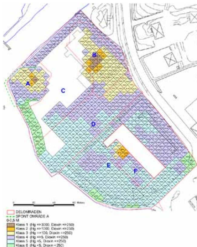
Figur 6.4: Exempel på schaktplan med förklassificering
