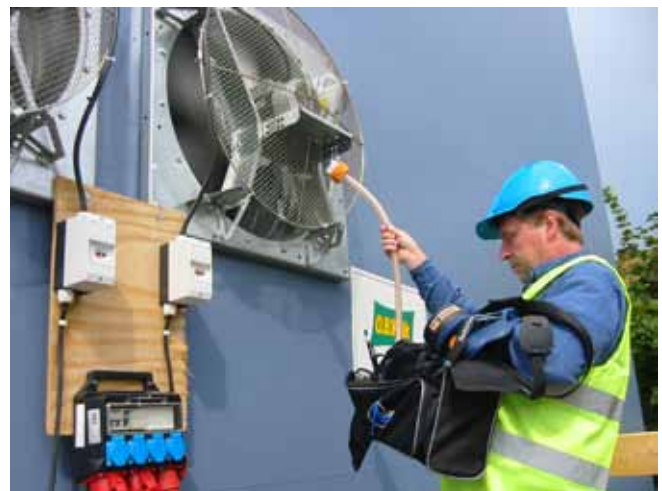
Figur 7.22: Mätning av spridning av föroreningar i luft ut från tältet
