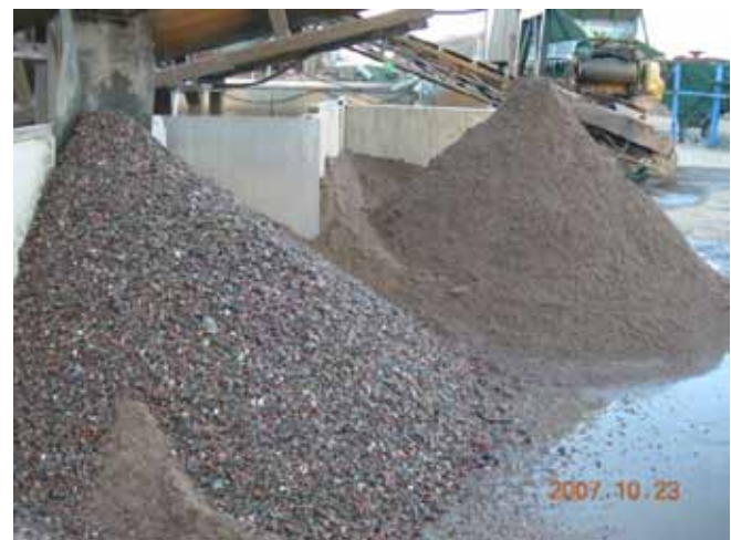
Figur 7.21: Siktade jordmassor med det tvättade grova materialet till vänster, bilden är från Sakab
