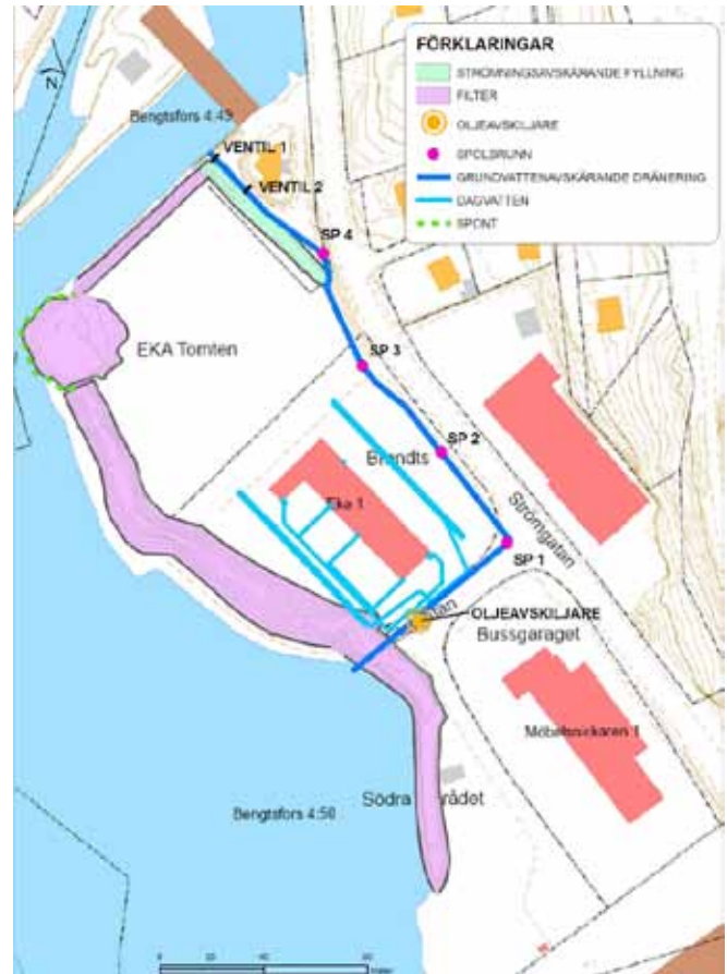
Figur 7.8: Grundvattenavskärande dräneringssträckning med spolbrunnar, oljeavskiljare och avstängningsventiler
