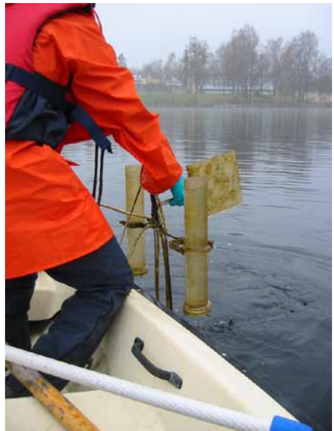
Figur 8.4: Provtagning med sedimentfällor
