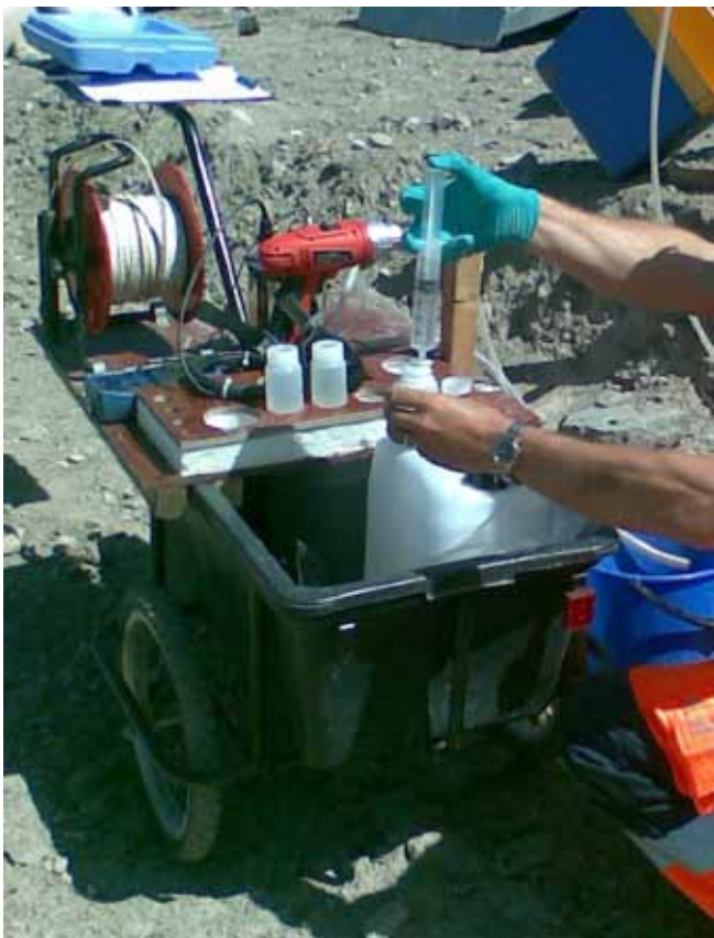
Figur 8.2: Provtagning av grundvatten
