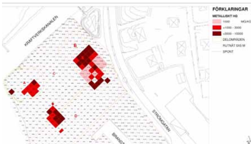
Figur 9.1: Områden inom vilka metalliskt kvicksilver hittades i schaktmassorna. Dessa låg inom A-området ("Udden"), B-området ("Fabriksområdet") och vid gränsen mellan C- och D-området ("Stenkistan")
