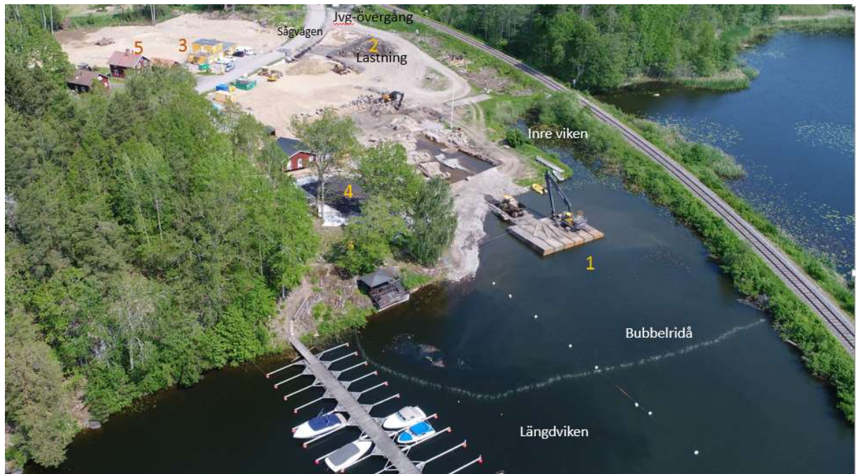
Figur 4 Entreprenadsområde Bestorps f.d. såg. 1) Flotte för schaktmuddring, 2) Område för tillfällig mellanlagring inför lastning, 3) Etableringsytor, 4) Avvattningsytor 5) Bestorp 5:3
