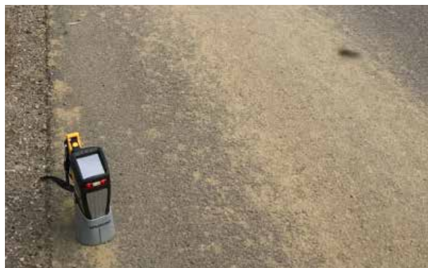
Mätning av förorening i hjulspår med XRF. Foto: Oskarshamns kommun
