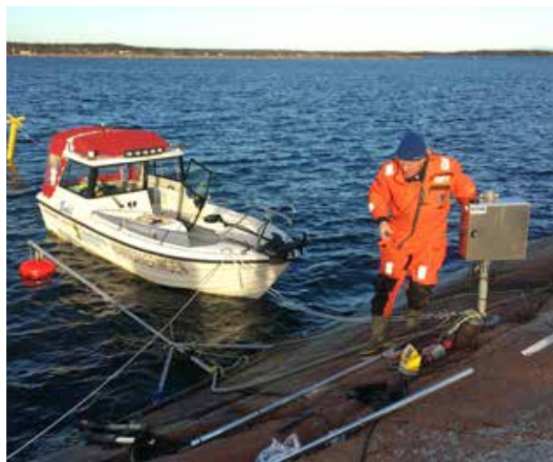
FTS utför service på de fasta turbiditetsmätarna i hamnbassängens inlopp. Foto: Oskarshamns kommun
