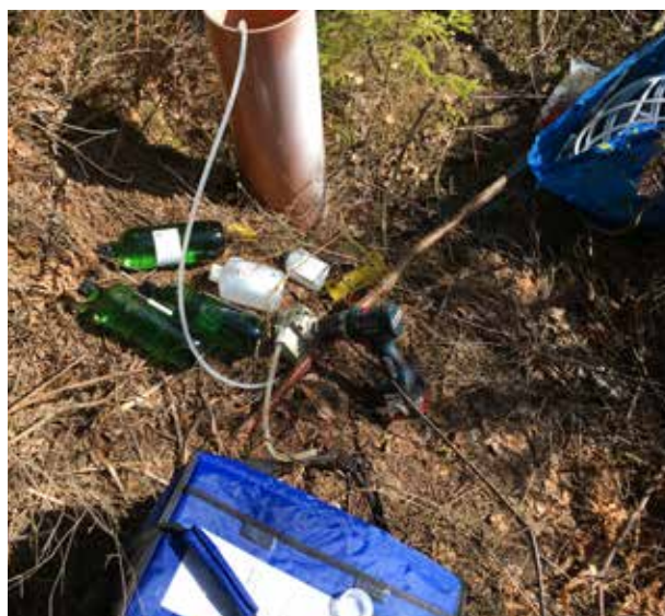
Provtagning i grundvatten i samband med omgivningskontrollen vid Storskogen. Foto: Oskarshamns kommun
