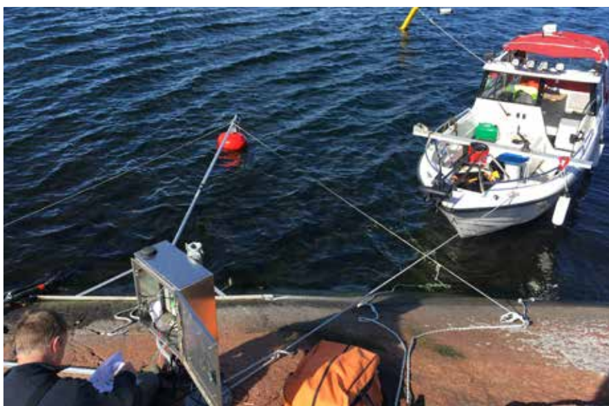
Till vänster: Stationära grumlighetsmätare som var utplacerade på var sida om hamninloppet. Bild till höger: Provtagning i bassänger för returvatten.
