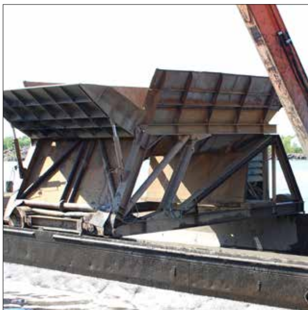
Avskiljningsgaller för block och sten med lemmar för att undvika spill. Foto: Oskarshamns kommun
