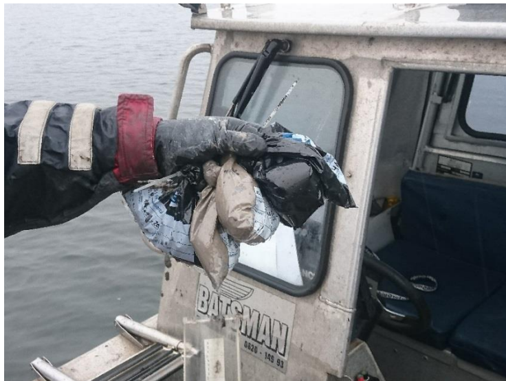
Figur 4: Sedimentprovpåsar rullförslutna med buntband. Varje påse innehåller 10cm av en sedimentkärna, i detta fall 0,28dm 3 .
