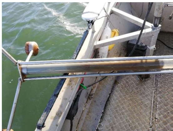
Figur 2: Sedimentkärna (90cm) i rörhämtaren "Apello". Tre separata skikt kan ses. Från ytan: brun gyttja, brunbeige sand samt ljusgrå lera.
