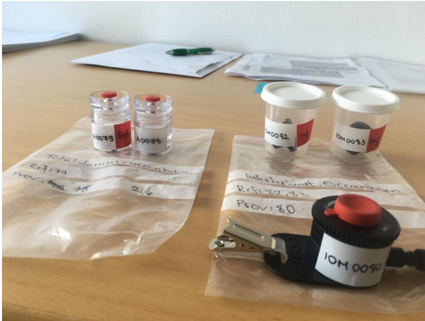
Bild 3: Filter med tillhörande referens för inhalerbart damm och totaldamm skickas till ALS för analys.
