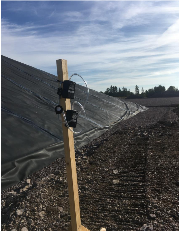
Bild 2: Provtagning mellan sedimenthögar (se röd markering). Filter är placerat mot förhärskande vindriktning (SW).
