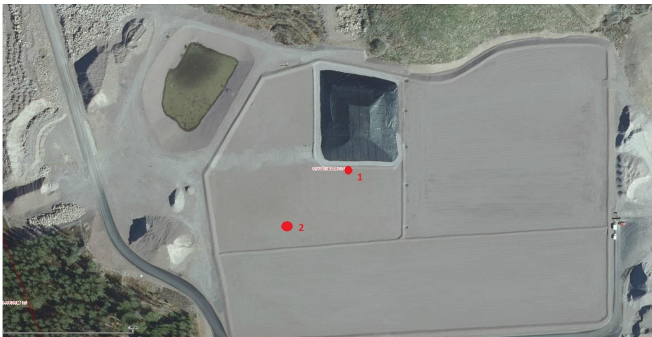
Bild 1: Bild över Storskoens deponi. Placering av kassett (se röd markering) vid ett provtagningstillfälle. Vid respektive provpunkt utfördes två provtagningar.
