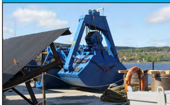
Figur 5.4 Exempel på slutet s.k. miljöskopa avsedd för muddring av förorenade sediment. Foto: Trafikverket.
