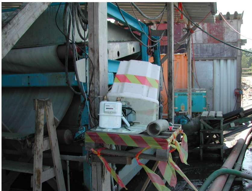
Bild 3. Luftmätning av PCB/PAH och kvicksilver vid avvattningsanläggningen, Örserumsviken. Foto: Christer Ramström.
