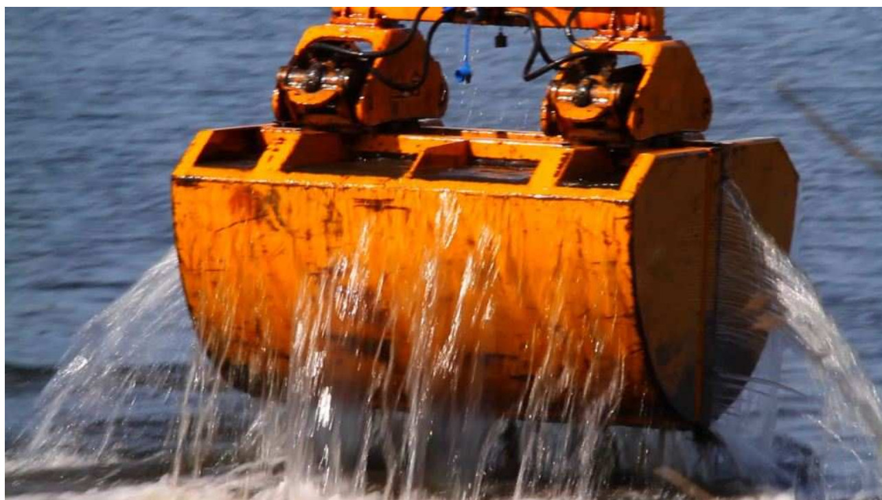
Figur 3 Gripskopa vid lyft från vattnet.
