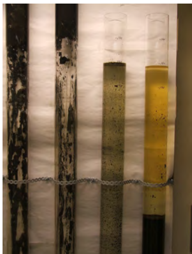
Bild 3. Rör II-V. Rören II och III är upphängda upp och ner för tömning av slam. Observera vidhäftningen på rörväggarna. Sedimenteringen i rör IV hade pågått i 19 timmar och i rör V 17 timmar.
